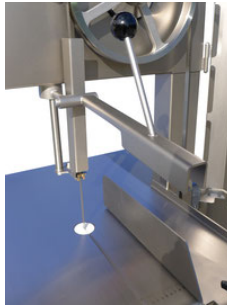
Produktpåskjutare kan sättas fast. Vissa kunder föredrar att få den i en icke flyttbar design. Säkerhet i första hand..
