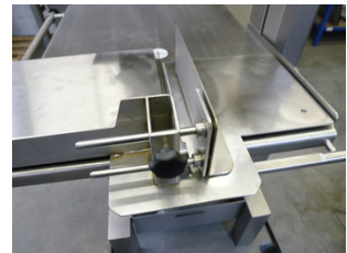
Glidbord med extra stöd för den avkapade delen och ett rörelselänkat kapmått.
