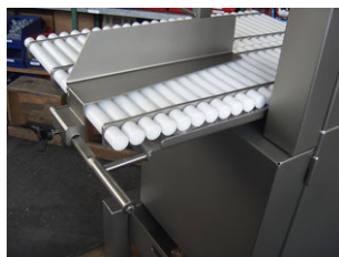
Inga kullager krävs. Rullar är gjorda av en massiv plastbit. Absolut hygieniskt.
